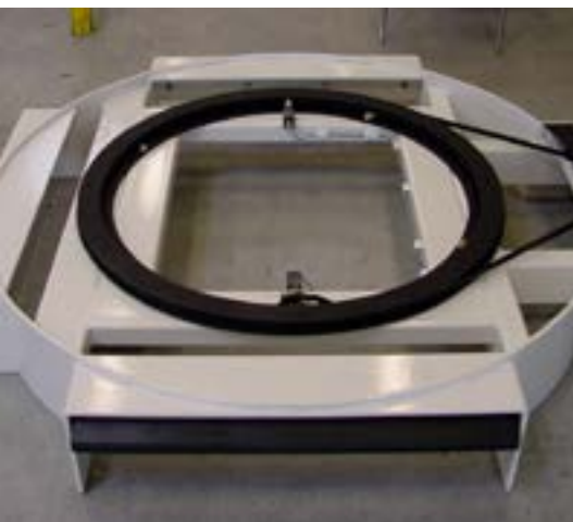
Frekvensstyret remtræk med spændebeslag til rotation af drejetallerkenen.
